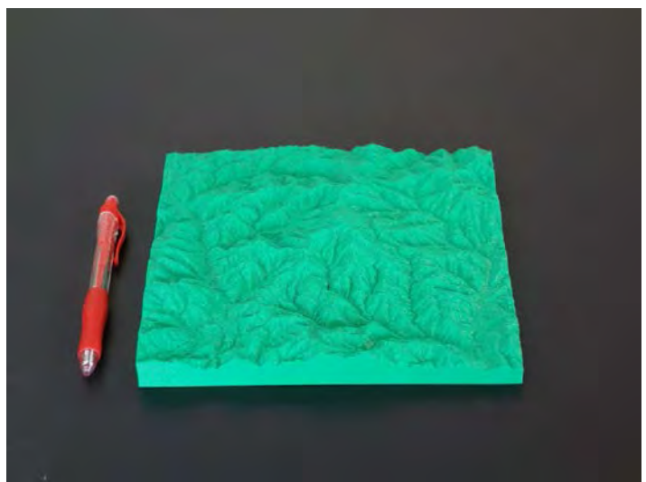
図1 3Dプリンターによって試作した、白山地域の3Dアナログ地形モデル。高さ方向を2倍に強調したもの。
