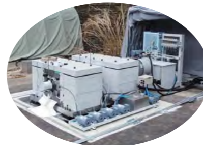
最新設計によるACROSS電源装置 基礎や電源のローコスト化が図られている。
