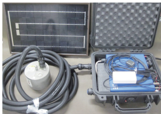
開発中の地震テレメータ装置と地震計・10Wソーラーパネル
