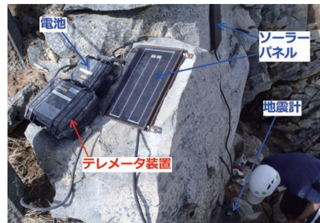
開発したテレメータ装置を用いた御嶽山での観測点設置の様子
